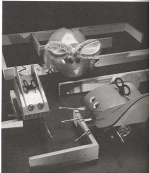
**Ariadne NXT:** Robô NXT da Lego que é capaz de encontrar a saída do Labirinto, utilizando dois algoritmos: *Seguir a Parede* e *Pledge*.
