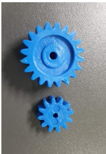
*Figura 6: Rodas dentadas. É necessário ter atenção aos diâmetros interiores.*
