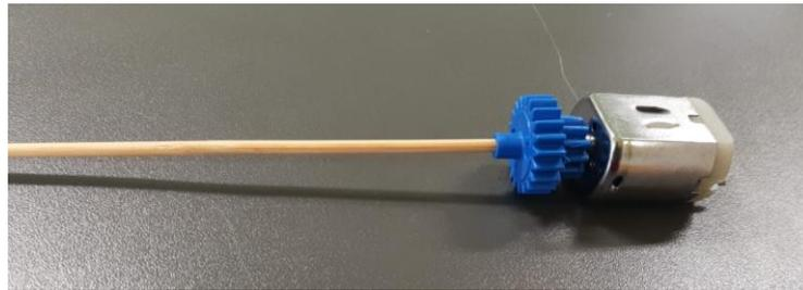
*Figura 8: Montagem do eixo do rotor ao motor, com uso das rodas dentadas.*
