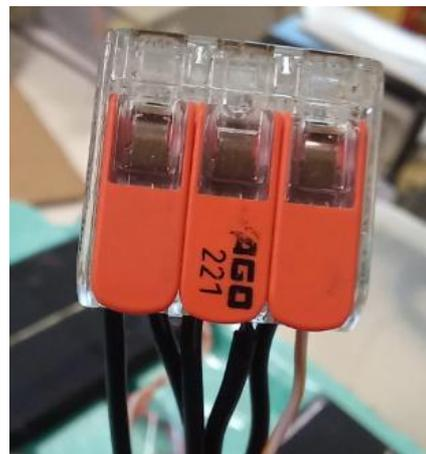
Figura 15: Régua de conectores com os cabos pretos.
