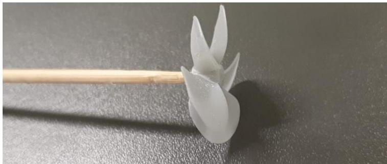
*Figura 10: Encaixe da hélice na vara de madeira.*
