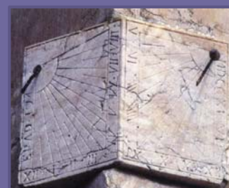
Par de relógios verticais declinantes, ocidental do lado esquerdo e oriental do lado direito
