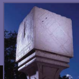
Conjunto de relógios verticais, sendo visíveis o mostrador oriental e o mostrador meridional
